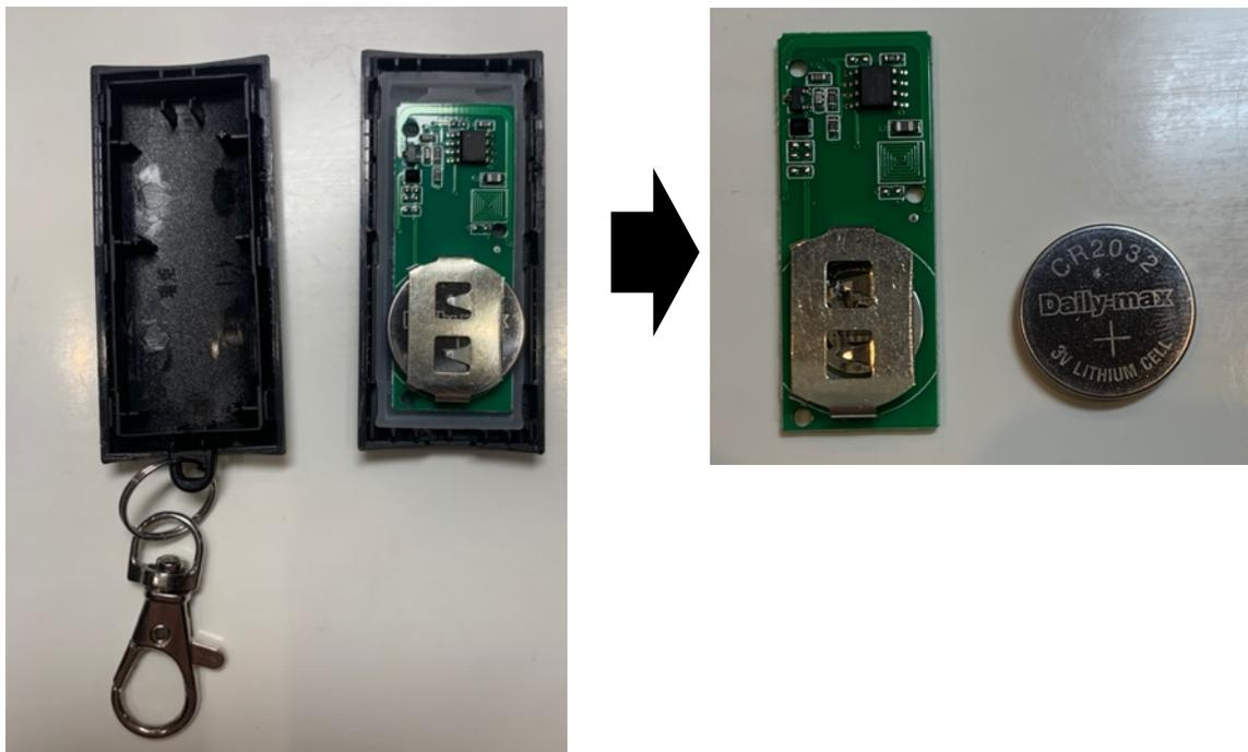
④ 新しい電池を入れ、リモートキーを再び組み立てる
