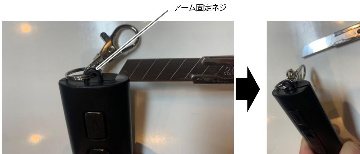
③ リモートキーのカバーから中の基板を取り出し、電池を外す
